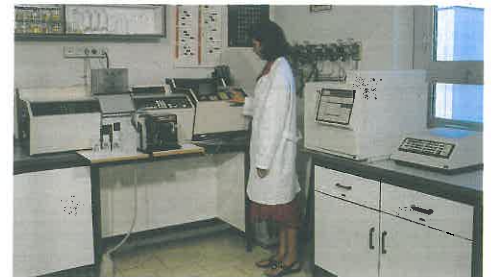
Controllo qualitativo del campione prelevato a mezzo spettrofotometro ad assorbimento atomico.
